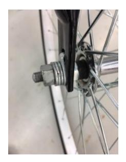
JIS D 9301(一般用自転車)で突起物は、「おねじが締付け相手部分 (ナット面など)から、ねじの外径以上に長く突き出してはならない。」と 規定があります。
